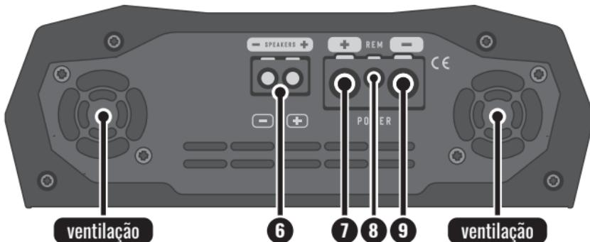
**6. CONECTOR DE SAÍDA (SPEAKERS):** Saída MONO do sinal amplificado para conexão dos alto-falantes.
