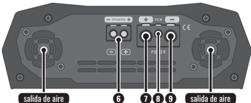
**6. CONECTOR DE SALIDA (SPEAKERS):** Salida MONO de la señal amplificada para conectar los altavoces. Verifique la impedancia mínima y las polaridades antes de instalar.
