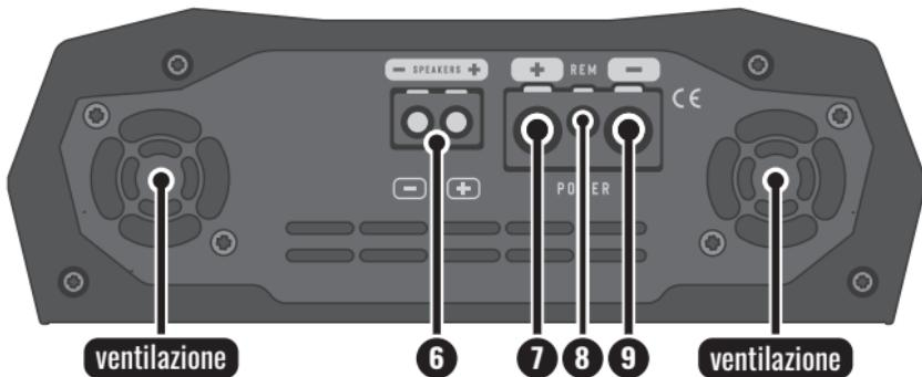
**6. CONNETTORE DI USCITA (SPEAKERS):** Uscita MONO del segnale amplificato per il collegamento degli altoparlanti. Controllare l'impedenza minima e le polarità prima dell'installazione.
