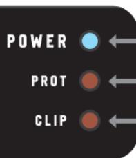
**POWER (LED blu):** Indica il funzionamento dell'amplificatore quando è acceso.
