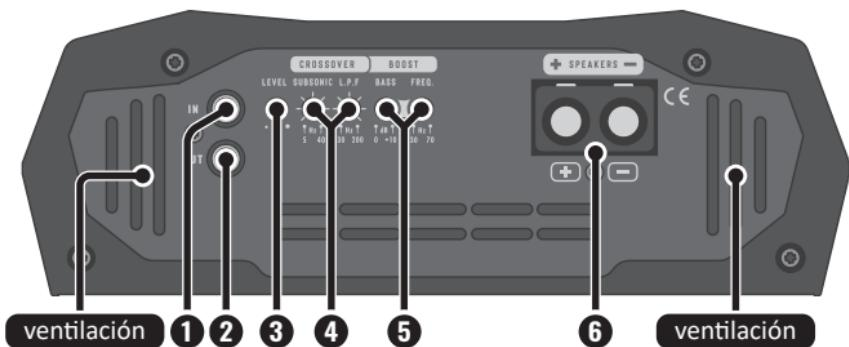
**1. INPUT (IN):** Entrada de la señal que se amplificará. Conéctese a la radio/reproductor usando cables RCA blindados de alta calidad para evitar ruidos no deseados.
