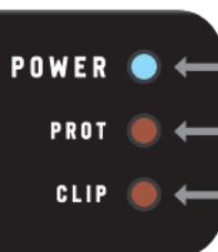
**POWER (LED azul):** Indica el funcionamiento del amplificador cuando está encendido.
