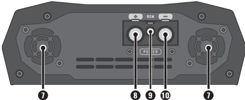
**7. COOLER:** Fornisce il raffreddamento dell'amplificatore. Installarlo in un luogo ben ventilato, senza ostruire le entrate e le uscite dell'aria.
