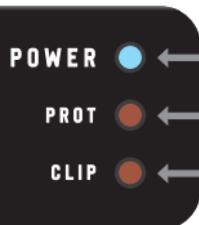
**POWER (LED azul):** Indica o funcionamento do amplificador quando aceso.
