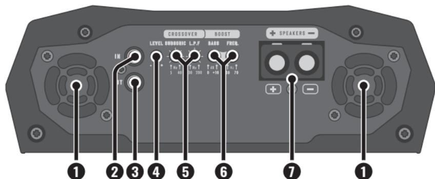
**1. COOLER:** Ele proporciona o resfriamento do amplificador. Faça a instalação em local arejado, sem obstrução das entradas e saídas de ar.
