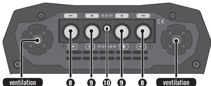
**8. CONNECTORE DOPPIO  $\ominus$  (TERRA):** Effettuare il collegamento con il terminale di terra della batteria utilizzando due cavi di almeno **70mm<sup>2</sup>** (uno per ogni ingresso negativo dell'amplificatore).
