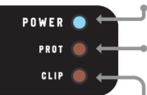
**POWER (LED blu):** Indica il funzionamento dell'amplificatore quando è acceso.
