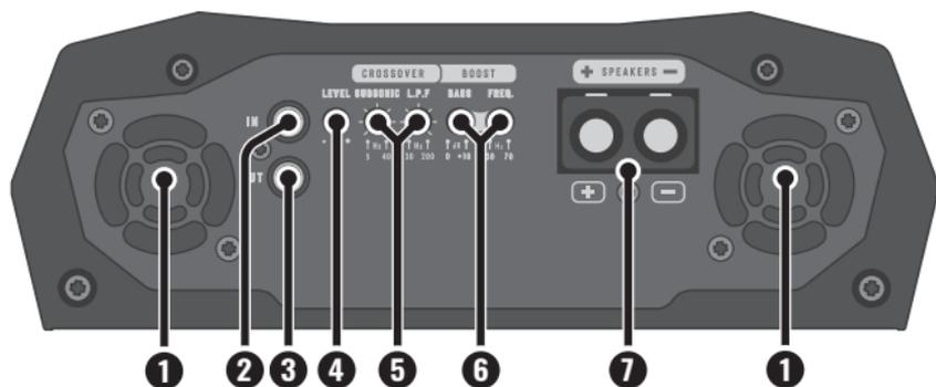
**1. COOLER:** Proporciona enfriamiento al amplificador. Instale en un lugar ventilado, sin obstrucción de entradas y salidas de aire.
