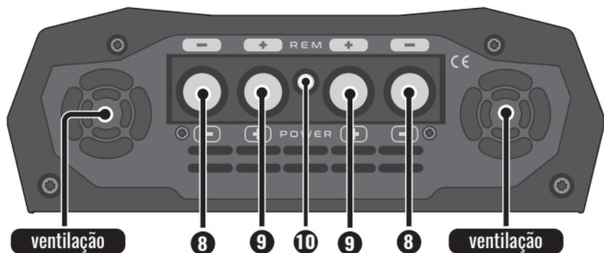
**8. CONECTOR DUPLO  $\ominus$  (TERRA):** Faça a conexão com o terminal terra da bateria utilizando dois cabos com no mínimo **70mm<sup>2</sup>** (um para cada entrada negativa do amplificador).
