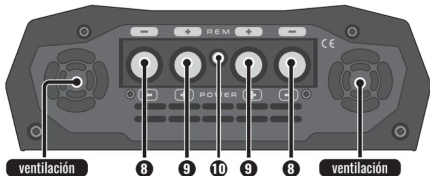
**8. CONECTOR DOBLE  $\ominus$  (TIERRA):** Realice la conexión con el terminal de tierra de la batería utilizando dos cables de al menos **70mm<sup>2</sup>** (uno para cada entrada negativa del amplificador).
