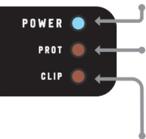
**POWER (LED azul):** Indica o funcionamento do amplificador quando aceso.
