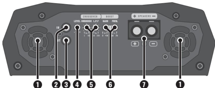
**1. COOLER:** Fornisce il raffreddamento dell'amplificatore. Installarlo in un luogo ben ventilato, senza ostruire le entrate e le uscite dell'aria.
