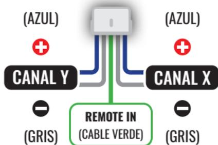
El uso de las conexiones de entrada RCA y HIGH INPUT al mismo tiempo puede causar ruidos no deseados y problemas con el amplificador.
