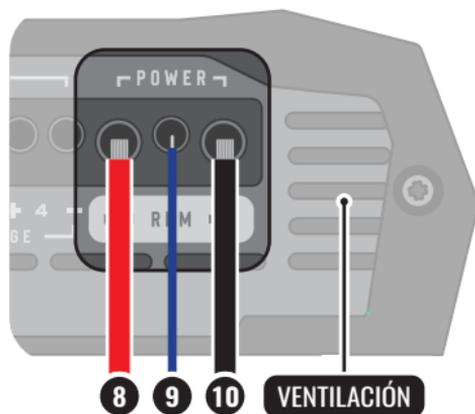
**10. CONECTOR NEGATIVO:** Conecte al terminal negativo de la batería con un cable de al menos **13,3 mm<sup>2</sup>**.
