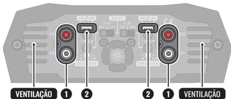
**1. CONEXÕES DE ENTRADA RCA:** Conjunto duplo de conexões RCA com 4 canais independentes (CH1 e CH2 / CH3 e CH4) identificados no amplificador. Faça as conexões com as saídas do rádio/player através de cabos RCA blindados de qualidade para evitar ruídos indesejados.
