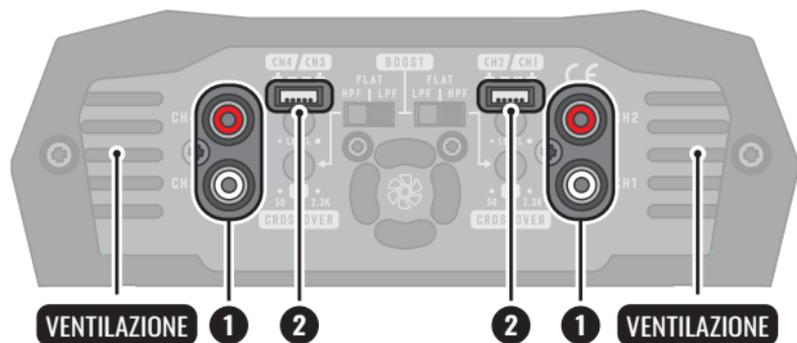
**1. CONNESSIONI DI INGRESSO RCA:** Doppio set di connessioni RCA con 4 canali indipendenti (CH1 e CH2 / CH3 e CH4) identificati sul prodotto. Collegare alle uscite radio/lettore tramite cavi RCA schermati di qualità per evitare rumori indesiderati.
