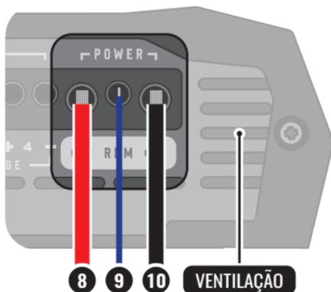
**10. CONECTOR NEGATIVO:** Conecte ao terminal negativo da bateria através de um cabo de no mínimo **13,3mm<sup>2</sup>**.
